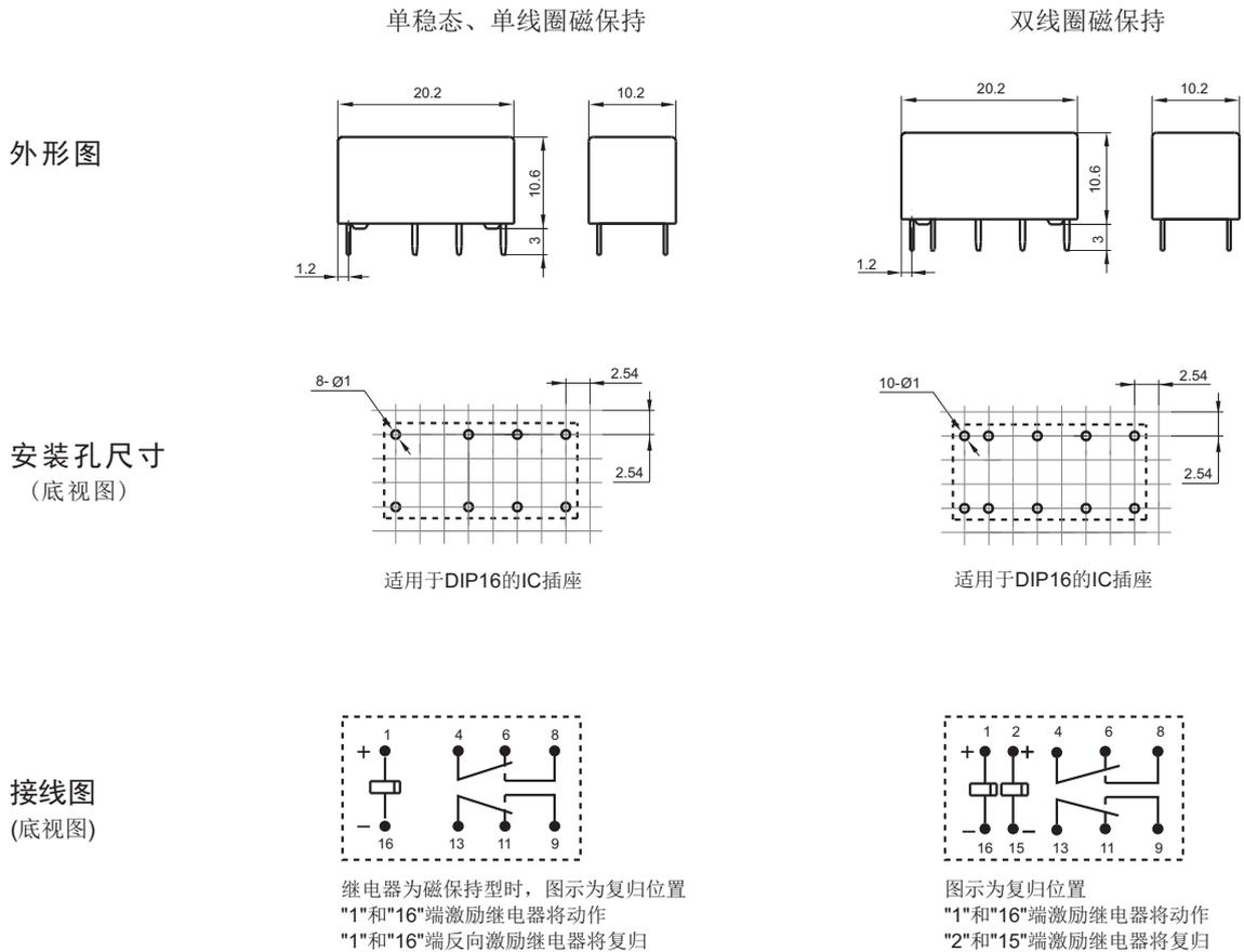
备注: (1) 产品部分外形尺寸未注尺寸公差, 当外形尺寸 $\leq 1\text{mm}$ , 公差为 $\pm 0.2\text{mm}$ ; 当外形尺寸在 $(1 \sim 5)\text{mm}$ 之间时, 公差为 $\pm 0.3\text{mm}$ ; 当外形尺寸 $> 5\text{mm}$ , 公差为 $\pm 0.4\text{mm}$ ;
