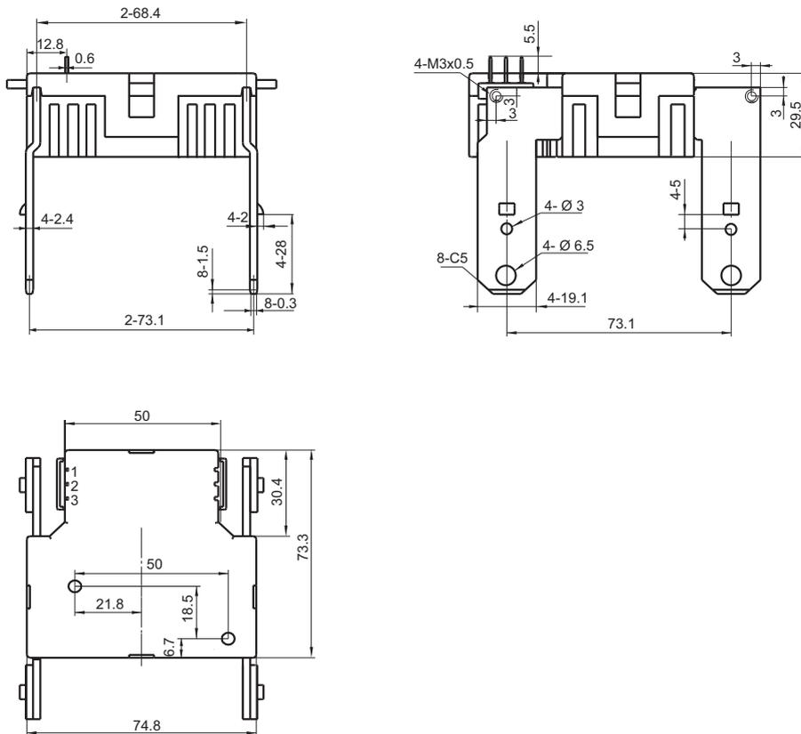
备注: 产品部分外形尺寸未注尺寸公差, 当外形尺寸 $\leq 1\text{mm}$ , 公差为 $\pm 0.2\text{mm}$ ; 当外形尺寸在 $(1\sim 5)\text{mm}$ 之间时, 公差为 $\pm 0.3\text{mm}$ ; 当外形尺寸 $> 5\text{mm}$ , 公差为 $\pm 0.4\text{mm}$ 。
