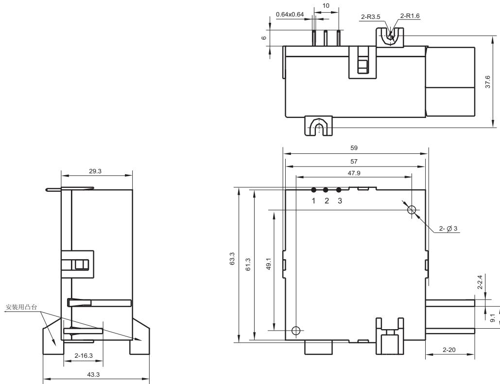
备注: 产品部分外形尺寸未注尺寸公差, 当外形尺寸 $\leq 1\text{mm}$ , 公差为 $\pm 0.2\text{mm}$ ; 当外形尺寸在 $(1\sim 5)\text{mm}$ 之间时, 公差为 $\pm 0.3\text{mm}$ ; 当外形尺寸 $> 5\text{mm}$ , 公差为 $\pm 0.4\text{mm}$ 。
